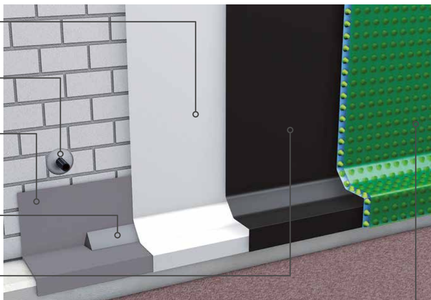
Systeemvoorbeeld: Afdichting volgens DIN EN 18 533
